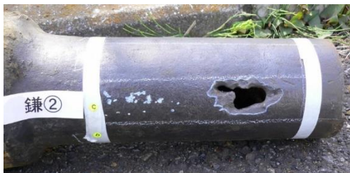
(水道管(1935年布設)の腐食状況)
