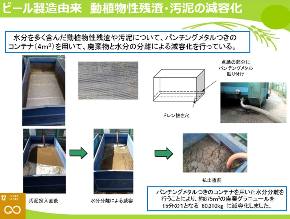
図3：特殊コンテナを用いた汚泥の減容化
