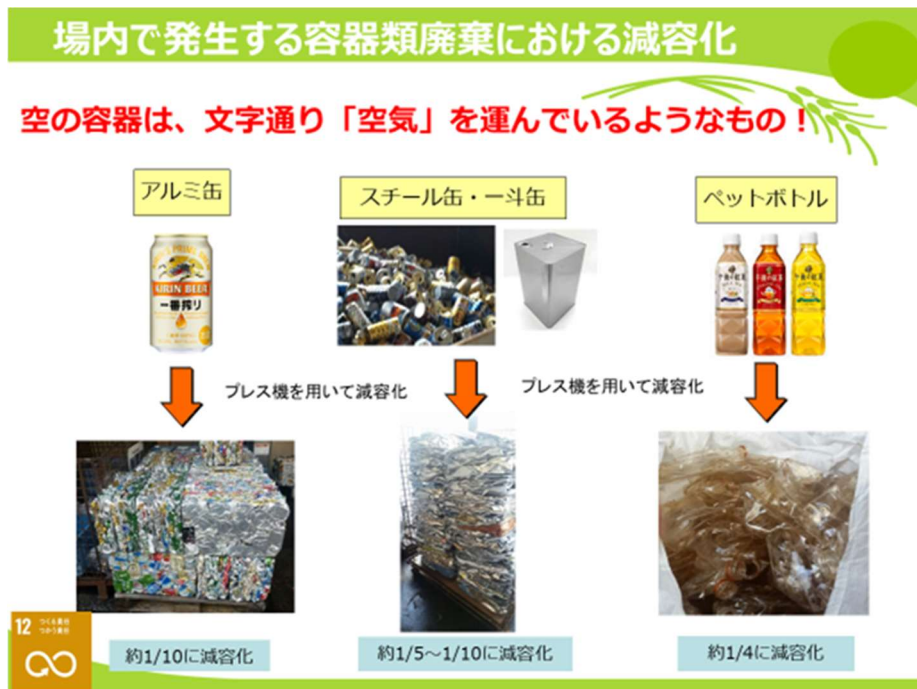
図2：圧縮機を用いた容器類の減容化
