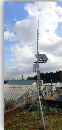
ICT機器： わな用遠隔監視装置
