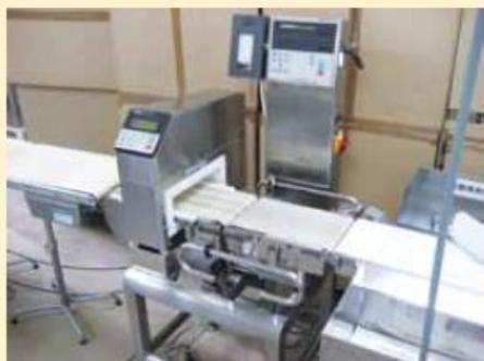
金属検出機は毎日作業前と作業後に、機械が正しく作動するか確認をしています。
