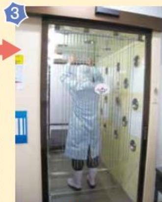
作業着のローラーがけのあと、さらに、エアシャワー室を通り抜けて、体に付いた異物を吹き飛ばしています。
