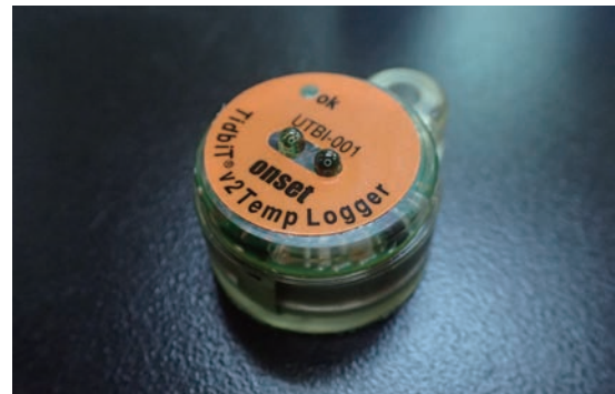
■写真26 地温計測に用いる温度ロガー
