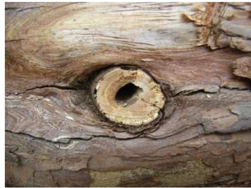
写真16 スギノアカネトラカミキリ枝打ち跡の孔
