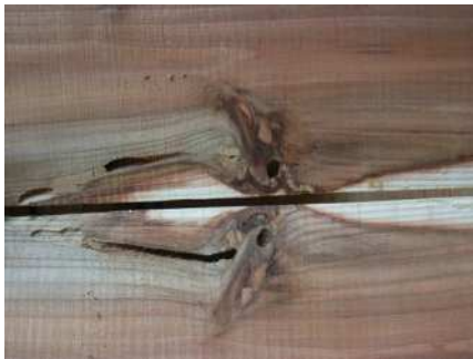
写真14 スギノアカネトラカミキリ被害材の断面
