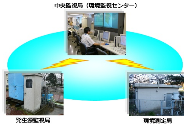
図 16 テレメータシステムの例（横浜市）
