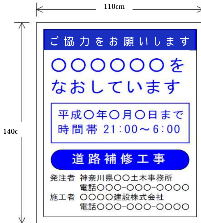
図1-1-2 工事中標示板の標準図
