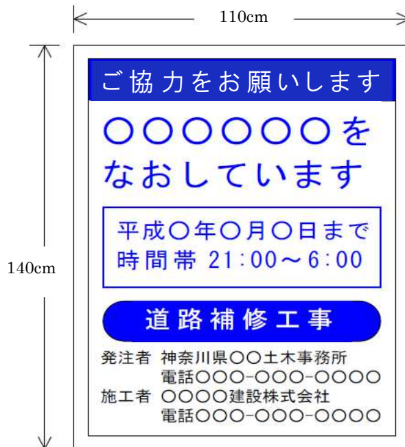
図1-1-2 工事中標示板の標準図
