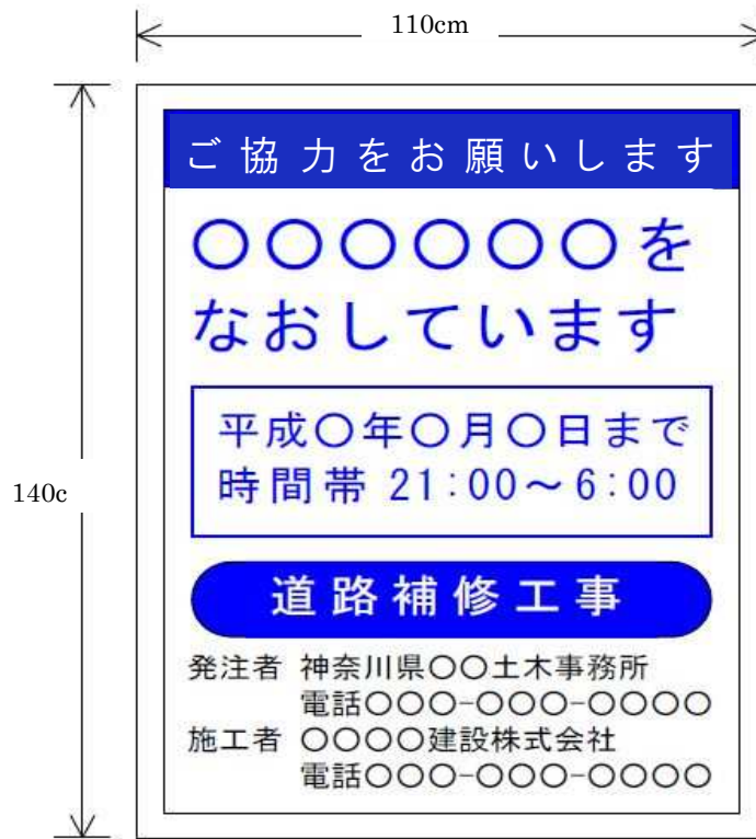
図1-1-2 工事中標示板の標準図
