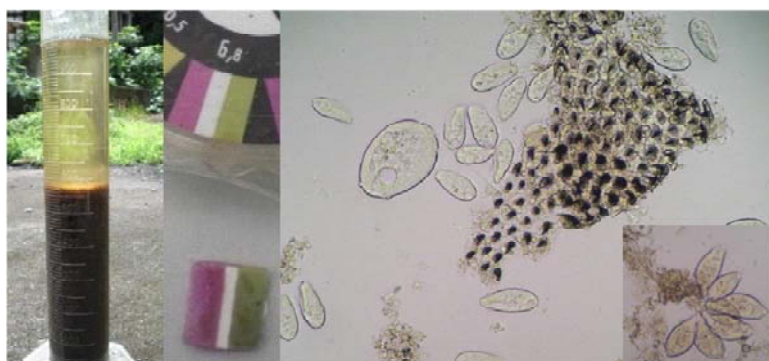
写真4 曝気槽混合液の性状観察（SV、pH、鏡検）
