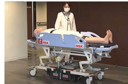
感染症対策ロボット例 (搬送アシストロボット)
