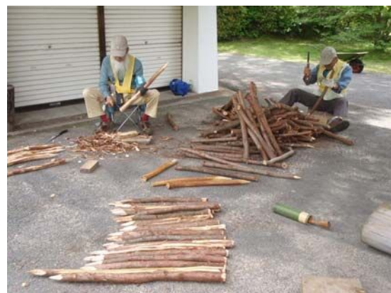
写真3 ヒノキの枝による杭づくり
