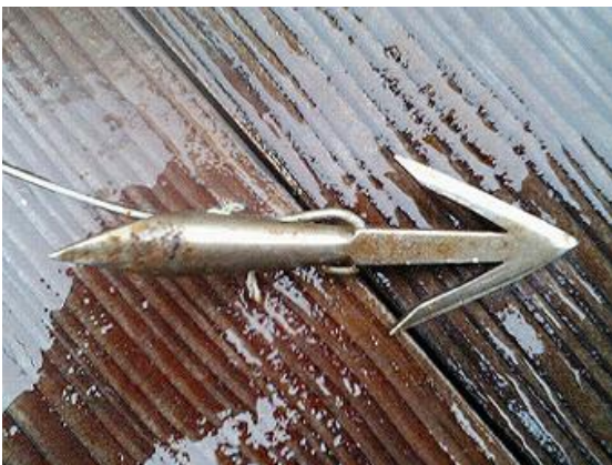
写真3 矢尻です。魚体にささると銚の柄からはずれます。
