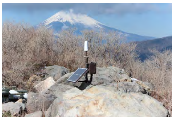
図 2-36 大涌谷に設置したリアルタイム GPS 観測装置 (原田・他, 2016)
