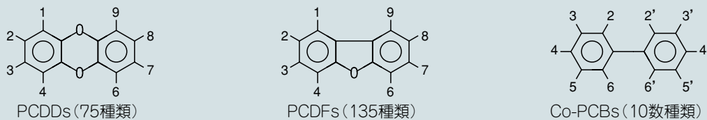
図20 ダイオキシン類の構造式（数字の付いた炭素原子に塩素原子が結合）
